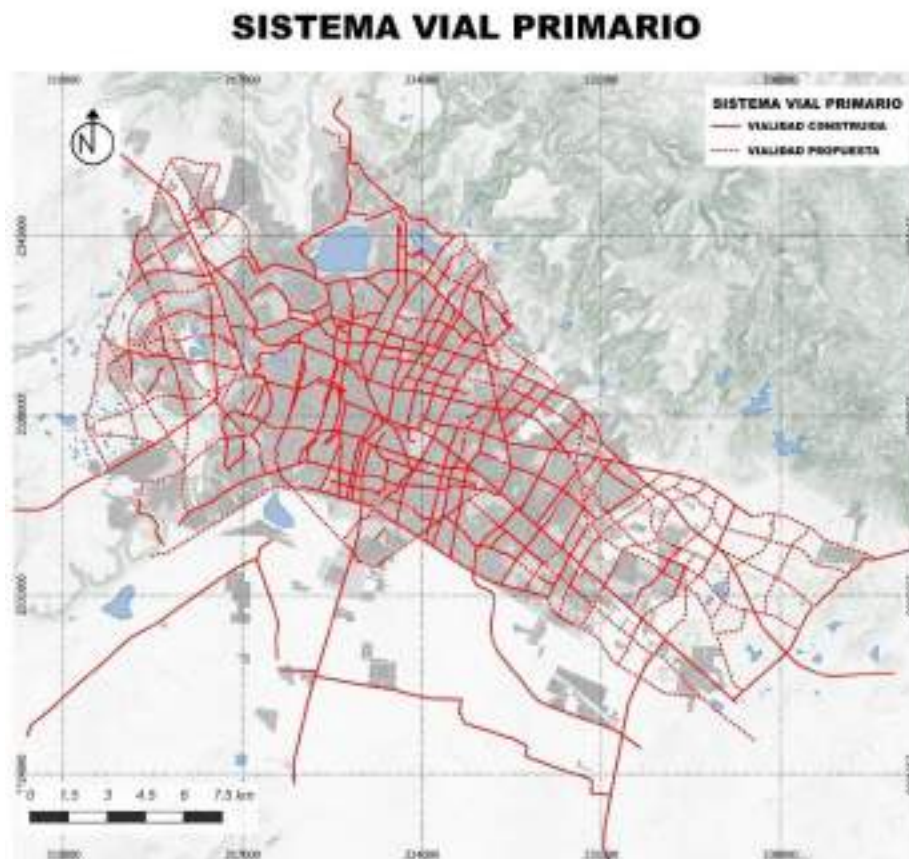
Mapa 4. Sistema vial primario de la ciudad de León, Gto. Fuente: IMPLAN 2024. Elaboración propia
